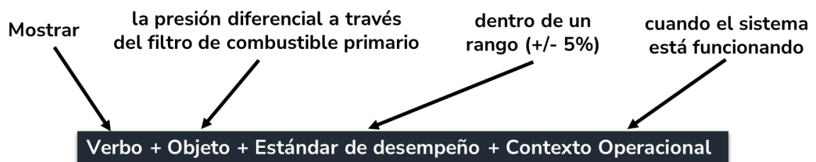
Figura 03-13. Descripción de la función del manómetro.
