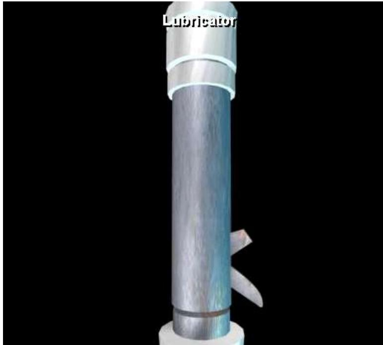
El lubricador permite la ecualización de la presión del pozo alrededor de la herramienta
