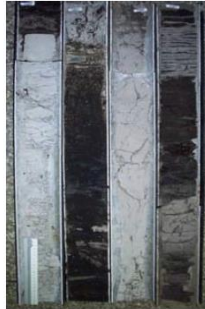
Fig. 3.18. Sucesiones de arena de grano fino impregnada de hidrocarburos entre paleosuelos caoliníticos con raíces in situ. Las arenas son interpretadas como depósitos de abanicos de rotura. Las cajas miden 3 pies de largo cada una. (Tomado de Casas et al. , 2007)
